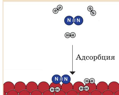
На поверхности катализатора молекулы разделяются на атомы
