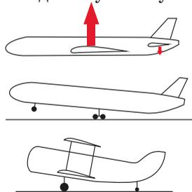
2. Чтобы самолёт набрал высоту, ему нужно задраить нос. Так как крылья прилагают силу к центру самолёта, то, управляя только оперением на крыльях, пилоты не могут повернуть самолёт, задрав его нос или хвост. Нужно толкать за «край» самолёта, далеко от центра тяжести. Как и при взлёте, оперируя оперением на хвосте, пилоты создают давление на хвост, направленное вниз.
